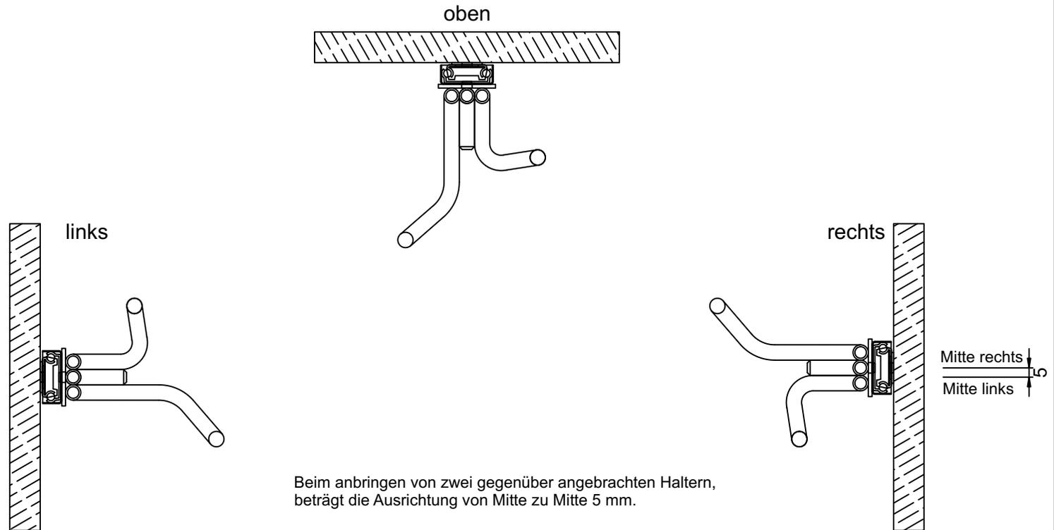
Beim anbringen von zwei gegenüber angebrachten Haltern, beträgt die Ausrichtung von Mitte zu Mitte 5 mm.
